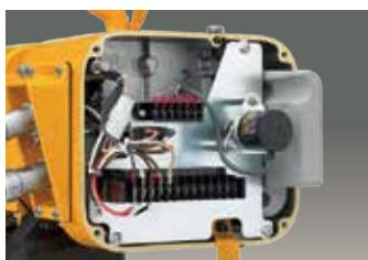
ギヤ減速軸の回転をエンコーダーにより信号として取り出し、別途シーケンサー(コントローラ、マイコン)等の組合せにより、任意の昇降位置の自動停止、起動および位置表示等、機能アップが図れます。
