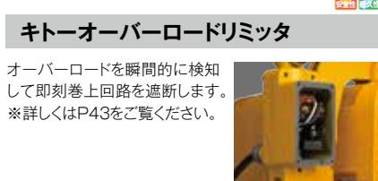
オーバーロードを瞬時に検知して即刻巻上回路を遮断します。
