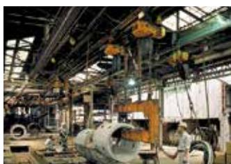
2台以上の電気チェーンブロックを1個の押しボタンスイッチで同時に操作できるタイプです。重量の割に容積が大きい品物、長尺物(コンクリート・鋼材等)などの運搬に適しています。
